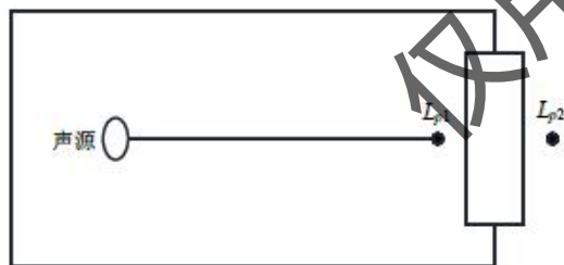
图 4-1 室内声源等效为室外声源图例
